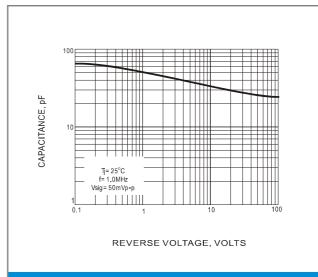
Fig.4 TYPICAL JUNCTION CAPACITANCE
