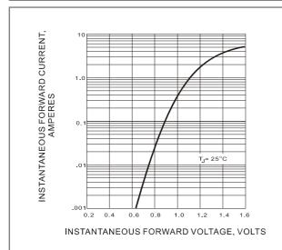
Fig.3-TYPICAL INSTANTANEOUS FORWARD CHARACTERISTICS
