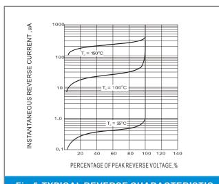
Fig.5-TYPICAL REVERSE CHARACTERISTIC
